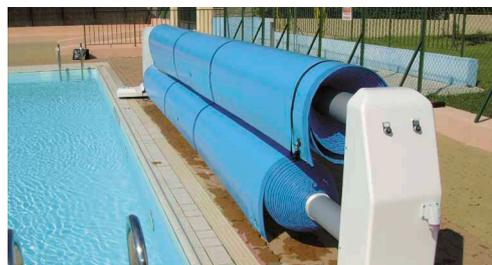
\* Pour l'enrouleur double axe manuel sont nécessaires 2 roues avec frein + 2 roues sans frein
