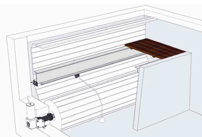
0 < Profondeur axe en dessous du niveau d'eau ≤ 0,55
