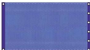
Renforts par bande PVC cousue sur les deux largeurs. Oeillet en inox sur une largeur tous les 60 cm environ pour les sangles de l'enrouleur. Un oeillet à chaque angle. Largeur maxi 6 m, au-delà la couverture est fabriquée en plusieurs parties.
