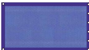
Renforts par bande PVC cousue sur tout le périmètre. Oeillet en inox sur une largeur tous les 60 cm environ pour les sangles de l'enrouleur. Un oeillet à chaque angle. Largeur maxi 6 m, au-delà la couverture est fabriquée en plusieurs parties.
