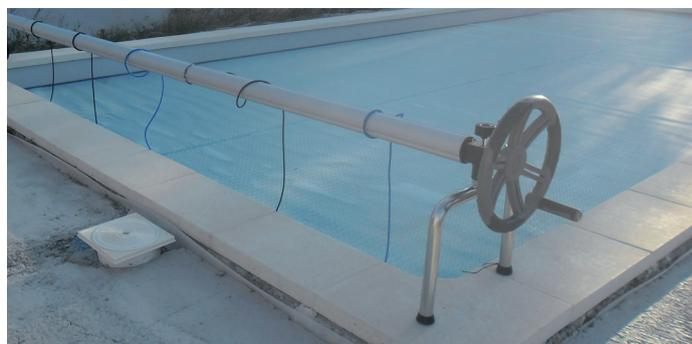
Enrouleurs télescopiques pour bâche à bulles. Pieds structure en inox AISI 304. Tube en aluminium anodisé incolore, 3 sections. Roues pleines. Volant en ABS avec système de freinage. Fixation de la bâche par sandows type cabiclics inclus. En option, enrouleur motorisable par kit moteur.
