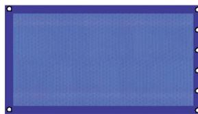
Renforts par bande PVC cousue sur tout le périmètre. Oeillets inox sur une largeur tous les 60 cm environ pour les sangles de l'enrouleur. Un oeillet à chaque angle. Largeur maxi 6 m, au-delà la couverture est fabriquée en plusieurs parties.
